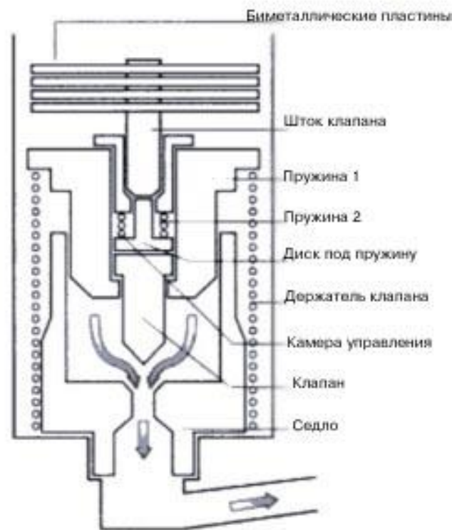
Конденсатоотводчик в разрезе
